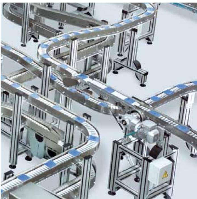
Il sistema modulare del sistema di trasporto a catena Rexroth di VarioFlow *plus* si compone di elementi universali, per sistemi di tutte le larghezze. Questo riduce il fabbisogno di spazio per l'utilizzatore.
