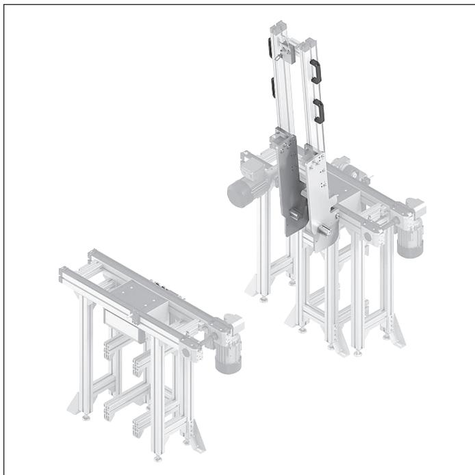
Il Lift Gate LG 2/H consente l'accesso o il passaggio a locali interni di un tratto a nastro (BS). Attraverso il rovesciamento manuale del tratto a nastro questo può
