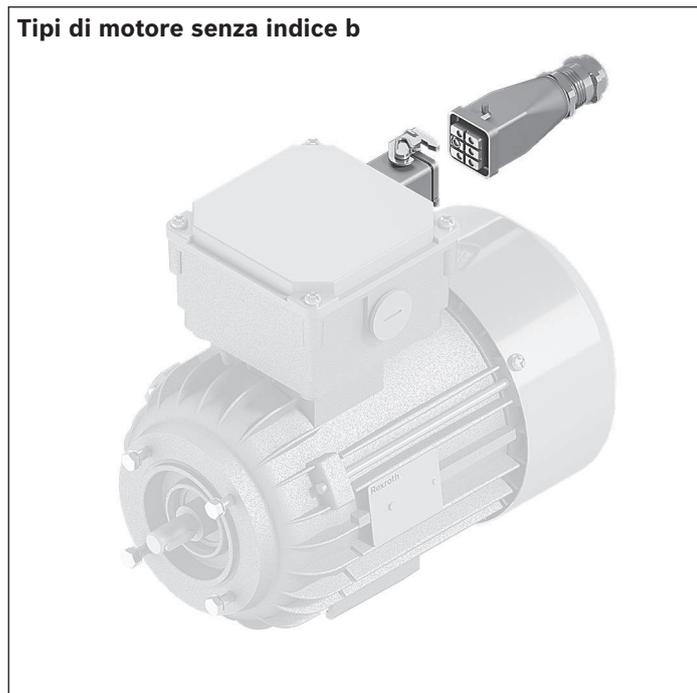
Collegamento del motore con connettore (AT = S) e connettore a spina industriale di metallo 3A per motore senza indice b, per es. 734
