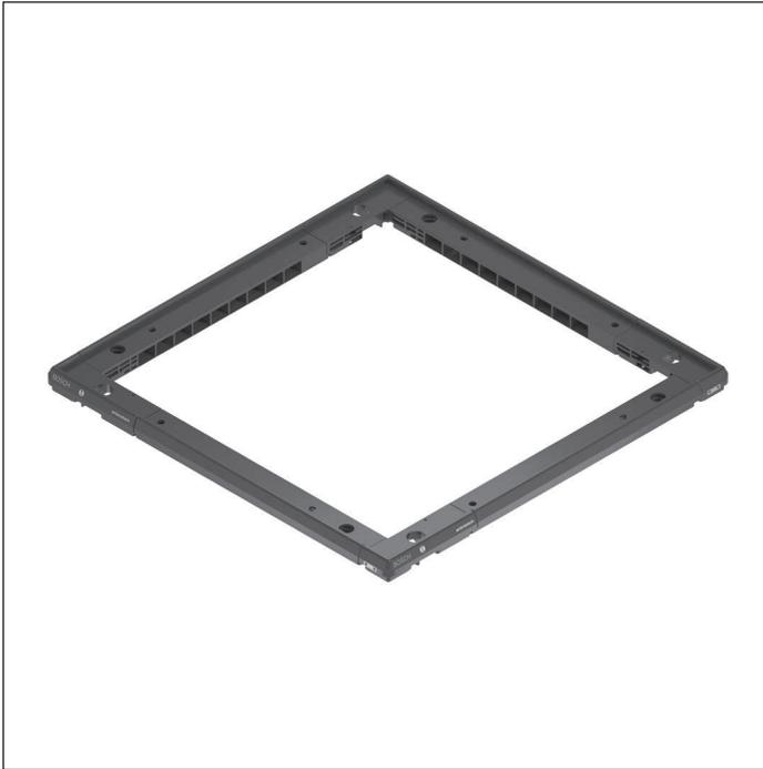
I moduli di telaio rinforzati servono per il montaggio autonomo di pallet con dimensioni a partire da 400 x 400 mm. Necessari per masse complessive del pallet > 50 kg o con velocità di trasporto  $v_N > 12$  m/min. In PA, sono le soluzioni base per l'impiego su tappeto/cinghia
