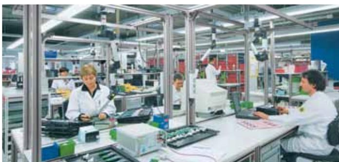
I componenti sensibili alla carica elettrostatica sono definiti ESDS (acronimo inglese che sta per Electronic Static Discharge Sensitive Device). Il danneggiamento di questi componenti produce costi elevati. Ogni danneggiamento implica una variazione irreversibile e quindi una riduzione della durata dell'ESDS. Determinante per la sensibilità di un ESDS è la tensione pericolosa del componente.
